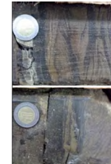
Intervalos delgados de rizaduras de arena café oscuro con impregnación de hidrocarburo Núcleo 1 del Pozo T
